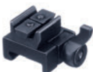
Aufkippmontage mit federnden Gegendruck-Klemmschiebern und 45°-Aufnahmeprismen. Kurze Ausführung
