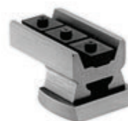
Vorderfuss verlängert, mit 45°-Aufnahmeprisma und Durchsicht. Gesamtlänge: 35 mm, Bauhöhe: 10 mm
