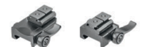
Aufkippmontage mit federnden Gegendruck-Klemmschiebern für Swarovski SR-Zielfernrohre mit Innenschiene und Zahnprofil.
