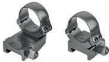
Aufkippmontage mit federnden Gegendruck-Klemmschiebern und schräggeteilten Ringen.
