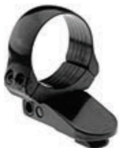
Vorderringe mit Verlängerung. Der Klemmring sitzt in einer Verlängerung mit Pivotzapfen und wird mit zwei Innensechskantschrauben geklemmt. Mit Toleranzausgleich. Bauhöhe: 13,5 mm, Ringbreite: 15,0 mm
