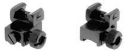
Aufkippmontage mit federnden, einstellbaren Gegendruck-Klemmschiebern u. 70°-Aufnahmeprismen für Zielfernrohre mit Mittelrohrschiene.
