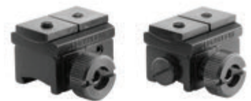
Aufkippmontage mit federnden, einstellbaren Gegendruck-Klemmschiebern für S&B-Convex-Schiene.
