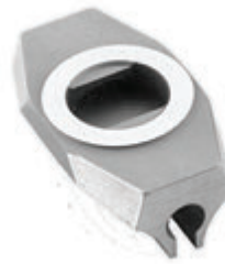
Schieneneinsatz mit vorgefräster Aussenform und Drehkranz für Pivotzapfen. Form unten geschlossen. Für Drillinge Kaliber 12 und 16. Länge: 38 mm
