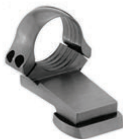
Vordere Klemmringe verlängert, ohne Durchsicht. Gesamtlänge: 45 mm, Ringbreite: 15 mm, Bauhöhe: 12 mm
