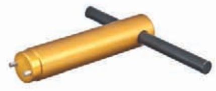
Zapfenlager für großkalibrige Repetierbüchsen in besonders robuster Ausführung. Die beiden Lochschrauben ermöglichen die Einstellung auf verschieden breite Schäfte sowie eine mittige Positionierung der Gewindebuchse. Die Abflachungen und die Aussparung am Zapfenlager garantieren eine große Anlagefläche am System.
