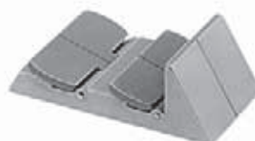
Super-Express-Visier mit zwei unterschiedlich hohen Klappen und Standvisier (Höhe 12 mm). Prisma 30° / Länge 36 mm / Breite 18 mm
