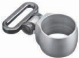
Standard-Ringriemenbügel für Repetierbüchsen. Kopfbreite: 6 mm; Bohrung: ø 3,0 mm.
