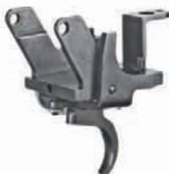
Dieser Flintenabzug für Repetierer Mauser 66 kann gegen den vorhandenen Stecher ausgetauscht werden. Ein Wechsel des Abzugsbügels ist notwendig. Das Abzugsgewicht ist einstellbar. Bei den Modellen Mauser 66 Magnum und solchen ohne Schlosshalter ist vom Einbau abzusehen. Not suitable for models Mauser 66 Magnum or those without bolt stop!
