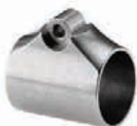
Magnum-Ringriemenbügel mit zylindrischer Aussenform, für Repetierbüchsen. Kopfbreite: 8 mm; Bohrung: ø 3,6 mm
