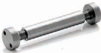
Zapfenlager für grosskalibrige Repetierbüchsen. Mittels der beiden Lochschrauben kann bei unterschiedlichen Schaftbreiten die Gewindebuchse so eingestellt werden, dass diese immer mittig sitzt. Besteht aus einer Gewindebuchse und zwei Lochschrauben.
