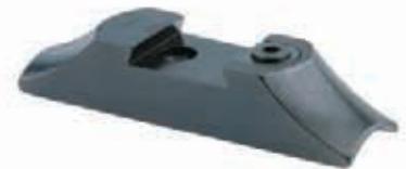
Visiersattel mit grosser Klemmbacke. Für alle Visiere mit 16 mm Prisma. Laufradius: R 9; BH: 5 mm
